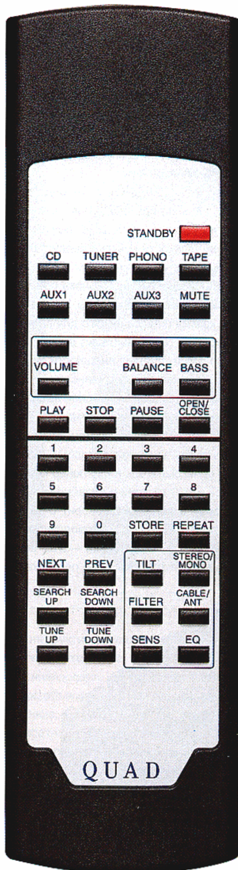
▲ В пульте предусилителя (слева) для регулировки НЧ-тембра предусмотрены отдельные кнопки, а включение ВЧ-фильтра и регулировка наклона начинают работать только после включения эквалайзера кнопкой EQ
